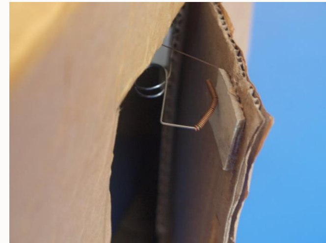
Дверне полотно надто швидко наближалось до дверної коробки, тому йому на зустріч був висунутий демпфер
